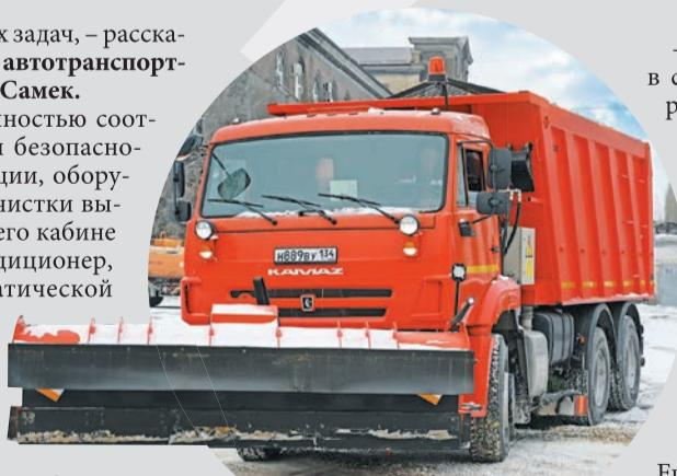
ным отвалом и щеточным оборудованием. Сейчас в кузове установлен пескоразбрасыватель, летом его поменяют на цистерну с водой.
